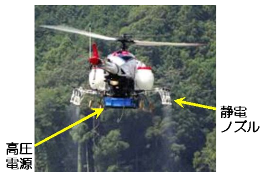
図4 無人ヘリ用静電散布装置(試作機)
